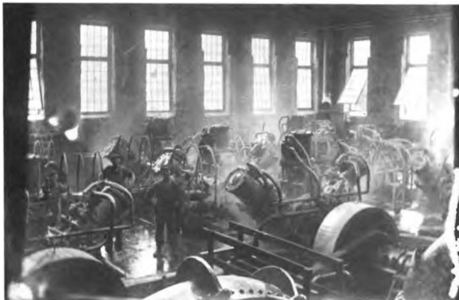
Groupe de défibreurs d'une force de 6,000 chevaux. Ces machines constituaient un nouveau modèle pour des billots de 30 pouces.
