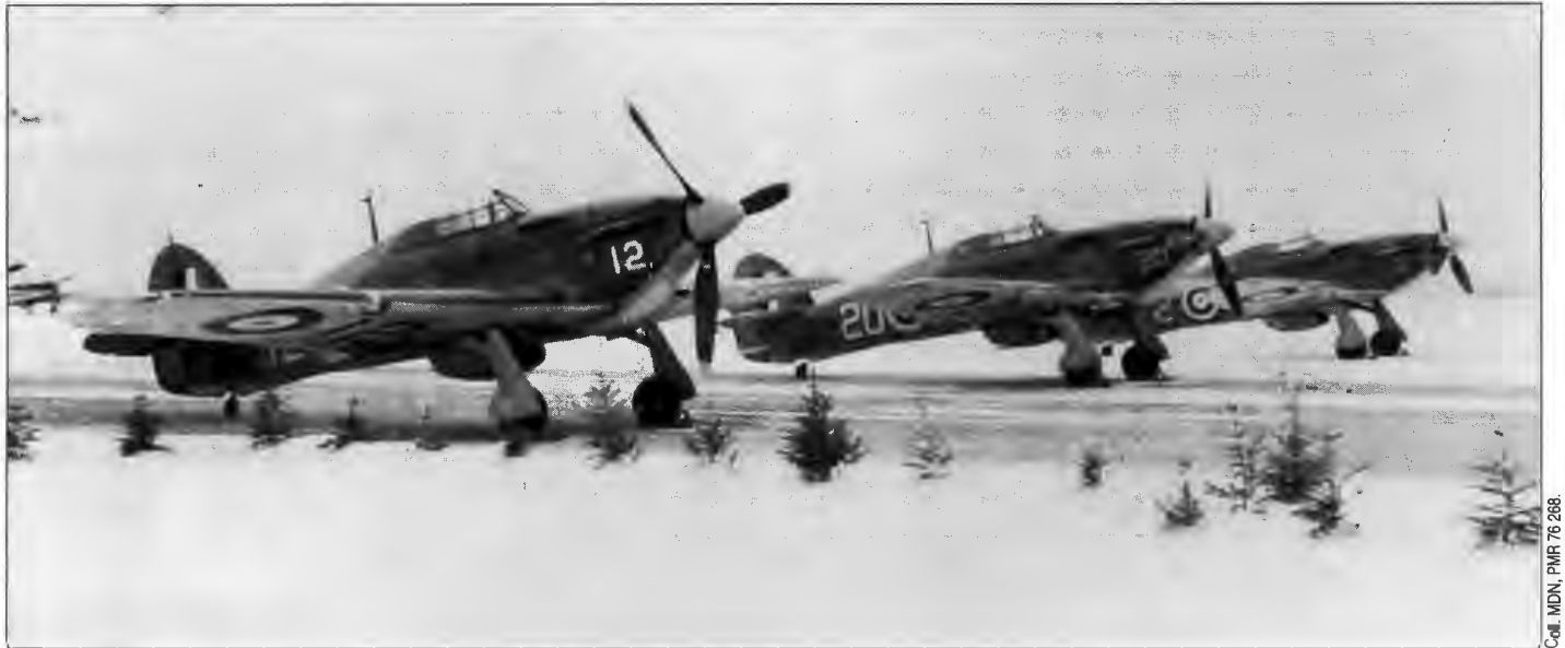
Hiver 1943, trois appareils de la 1ère UEO. On rapporte qu'il était fréquent que les moteurs de ces Hurricane, refroidis au liquide, refusent de démarrer à cause des rigueurs de l'hiver au Saguenay.
